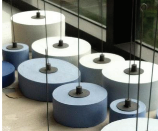
ภาพที่ 14 การประกอบชิ้นส่วนดินเผาเข้ากับก้านโลหะ โดยแป้นยึดโลหะที่ออกแบบให้มีส่วนตัวผู้และตัวเมียเพื่อยึดทะลุผ่านชิ้นงาน
