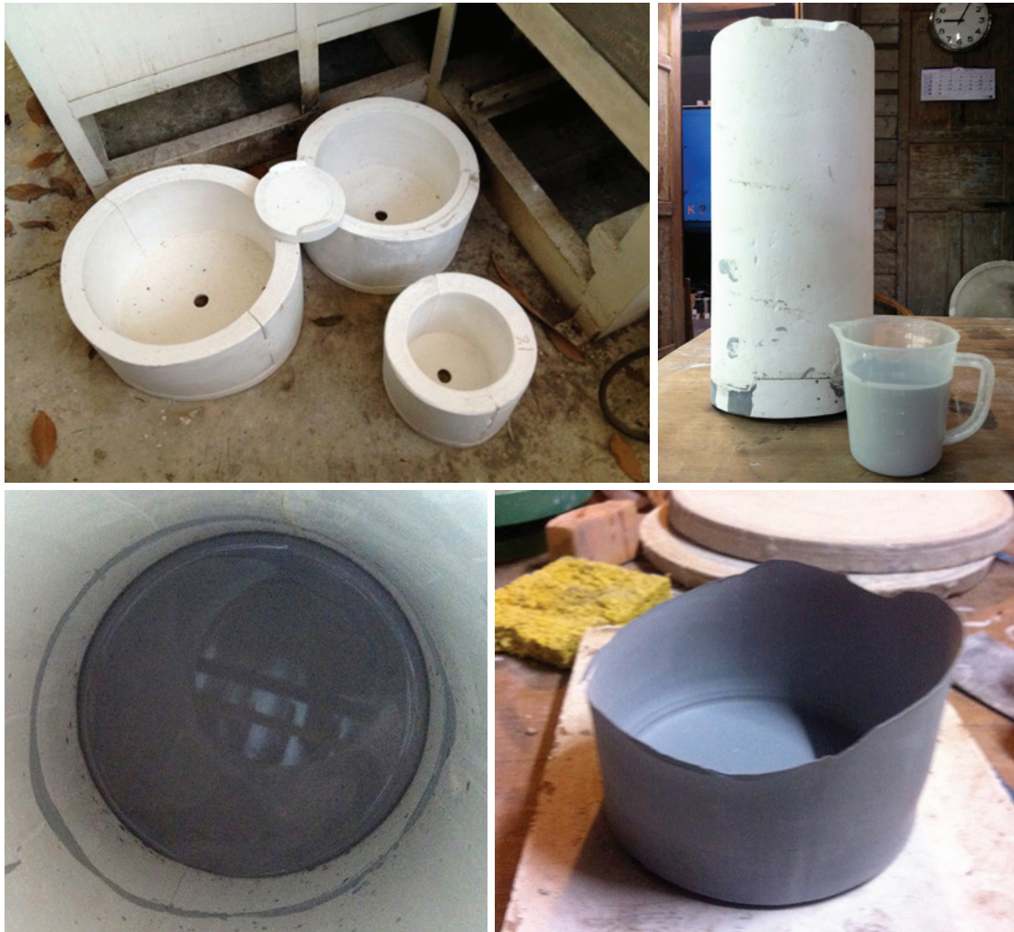
ภาพที่ 11 กระบวนการขึ้นรูป แม่พิมพ์ขนาดต่างๆ (ซ้ายบน) น้ำดินที่ผสมสีแล้วเตรียมเท (ขวาบน) น้ำดินขณะอยู่ในแม่พิมพ์ค่อยๆ ก่อตัวเป็นผนังของชิ้นงาน (ซ้ายล่าง) และชิ้นงานดินที่แกะออกมาแล้ว รอการตัดขอบ เก็บความเรียบร้อยและเจาะรู (ขวาล่าง)
