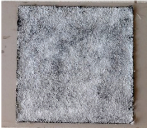
ภาพที่ 6 ชิ้นตัวอย่างแผ่นหลังคายางมะตอยจากส่วนผสมของขยะถุงพลาสติกที่เสร็จสมบูรณ์ขนาด 35x35x0.3 เซนติเมตร ที่มา : ผู้วิจัย
