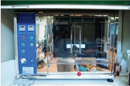
ภาพที่ 11 เครื่อง Flammability Test Furnace, Model : HST-2 ที่มา: ผู้วิจัย
