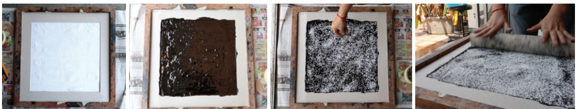
ภาพที่ 5 ขั้นตอนการเทยางมะตอยที่ผสมขยะพลาสติกลงในแบบหล่อ (1) แบบหล่อพร้อมติดตั้งแผ่นไฟเบอร์กลาส (2) เทยางมะตอยที่ผสมขยะพลาสติกเรียบร้อยแล้วลงในแบบหล่อ (3) โรยหินเกล็ดลงบนแผ่นยางมะตอย (4) ใช้แกนกระดาษกลิ้งทับผิวหน้า ที่มา : ผู้วิจัย
