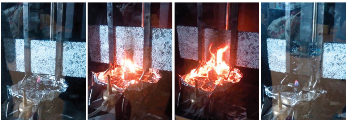
ภาพที่ 13 ขั้นตอนการทดสอบการลามไฟแนวนอน เรียงลำดับ 1-4 ที่มา: ผู้วิจัย
