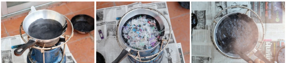
ภาพที่ 4 ขั้นตอนการต้มยางมะตอยผสมขยะถุงหิ้วพลาสติก (1) ต้มยางมะตอยให้ละลายจนอยู่ในสถานะของเหลว (2) ใส่ขยะถุงหิ้วพลาสติกที่สับย่อยละเอียดลงไปในยางมะตอย (3) คนยางมะตอยให้ผสมเข้าเป็นเนื้อเดียวกับพลาสติก ที่มา : ผู้วิจัย
