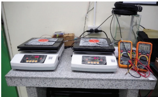
ภาพที่ 10 การทดสอบหาค่าสัมประสิทธิ์การนำความร้อน ที่มา: ผู้วิจัย
