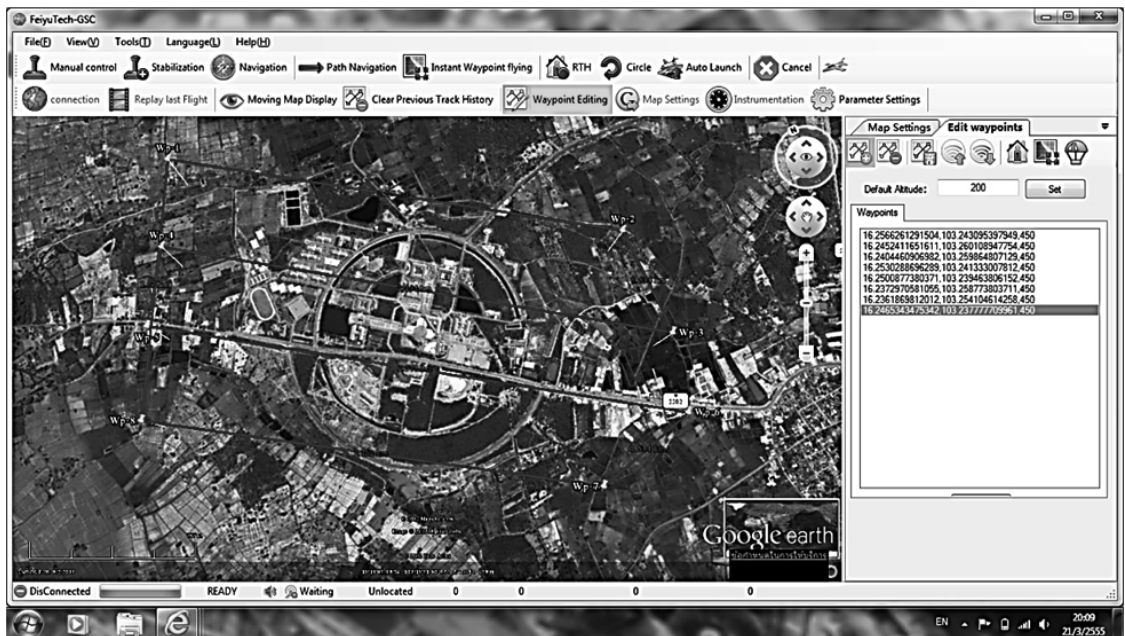
ภาพที่ 4 ตัวอย่างการกำหนดแผนการบิน ที่มา : โปรแกรม Ground Station Control (GCS)
