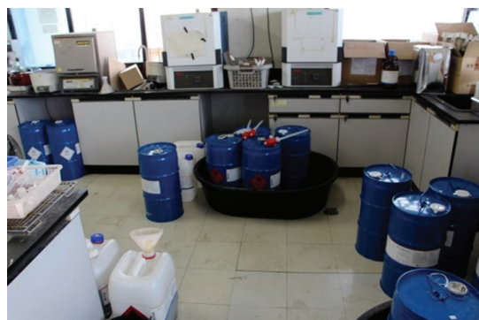
ภาพที่ 16 การจัดเก็บของเหลวไวไฟจำนวนมากภายในห้องปฏิบัติการ ซึ่งมีความเสี่ยงในการเกิดอัคคีภัยและระเบิดได้ หากเกิดอุบัติเหตุขึ้น
