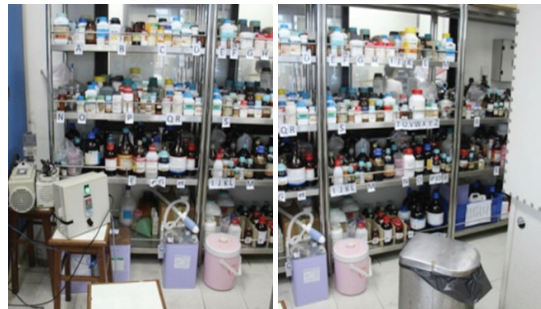
ภาพที่ 14 การจัดเก็บสารเคมีโดยเรียงตามตัวอักษร (ซ้าย และขวา) ซึ่งอาจก่อให้เกิดปัญหาด้านความปลอดภัยในการใช้อาคารและห้องปฏิบัติการได้
