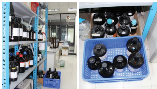
ภาพที่ 15 การจัดเก็บสารเคมีที่เป็นของเหลวอยู่บนชั้นในระดับที่สูง โดยปราศจากรางกันตกและภาชนะรองรับ มีความเสี่ยงในการตกลงมาแตกได้ (ซ้าย) และการจัดเก็บสารเคมีโดยมีภาชนะรองรับ ซึ่งมีลักษณะที่ไม่เหมาะสมเนื่องจากเป็นฉลากพลาสติกที่มีรูหรือบางส่วนเป็นกล่องกระดาษ (ขวา) หากมีการหกหรือไหลจะไม่สามารถรองรับสารเคมีได้
