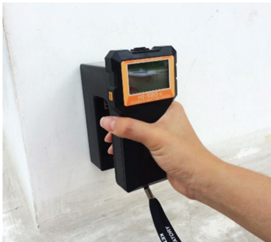
ภาพที่ 7 การใช้เครื่องมือ Concrete and Mortar Moisture Tester HI-520-2
