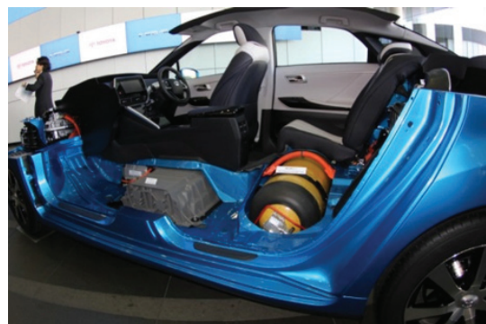
ภาพที่ 10 ภาพตัดตัวถังรถ โตโยต้า มิราอิ แสดงให้เห็นการจัดที่นั่งซ้อนอยู่เหนือถังไฮโดรเจน
