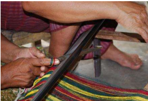
ภาพที่ 2 การสอดเส้นด้ายใส่ฟืมหรือฟันหวี ที่มา: เกษหทัย สิงห์อินทร์, 2557
