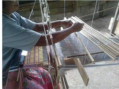
ภาพที่ 8 การก่อเขา (เก็บตะกอก) ลายดอก ที่มา: เกษหทัย สิงห์อินทร์, 2557
