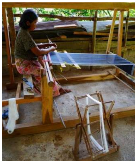
ภาพที่ 6 ไม้ก้ามปูและสวิงเครื่องมือและอุปกรณ์ ที่สำคัญในการก่อเขา (เก็บตะกอ) ที่มา: เกษหทัย สิงห์อินทร์, 2557
