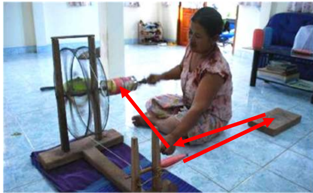
ภาพที่ 9 ทิศทางและตำแหน่งการโยงด้ายจากหลอดสู่แท่นตะปูและหมุนม้วนเข้ากระป๋อง ที่มา: เกษททัย สิงห์อินทร์, 2557
