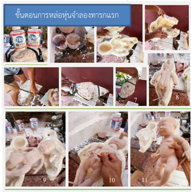
ภาพที่ 22 ขั้นตอนการหล่อหุ่นจำลองทารกแรก ที่มา: บุญเสริม วัฒนกิจ
