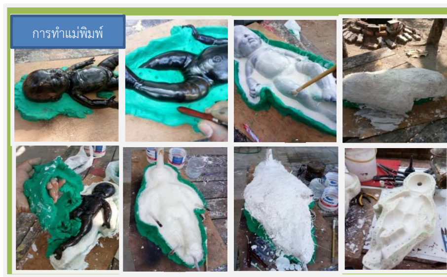
ภาพที่ 12 การทำแม่พิมพ์ทารก
