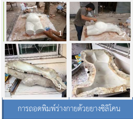
ภาพที่ 11 การถอดพิมพ์ร่างกายด้วยยางซิลิโคน
