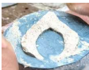
ภาพที่ 6 การทดลองสร้างแม่ลายเพื่อกดเนื้อปูน และประกอบเป็นลวดลายพื้นฐาน ที่มา : นกมล สักวาลเพชร
