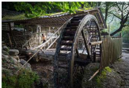
ภาพที่ 1 ครกกระต๋องพลังน้ำของหมู่บ้านเร้าหนาน
