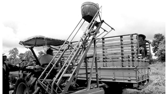
รูปที่ 4. รถบรรทุกและอุปกรณ์ลำเลียงมันสำปะหลังวิ่งควบคู่ทำงานไปด้วยกันโดยมีอุปกรณ์ลำเลียงช่วยลำเลียงด้านข้าง
