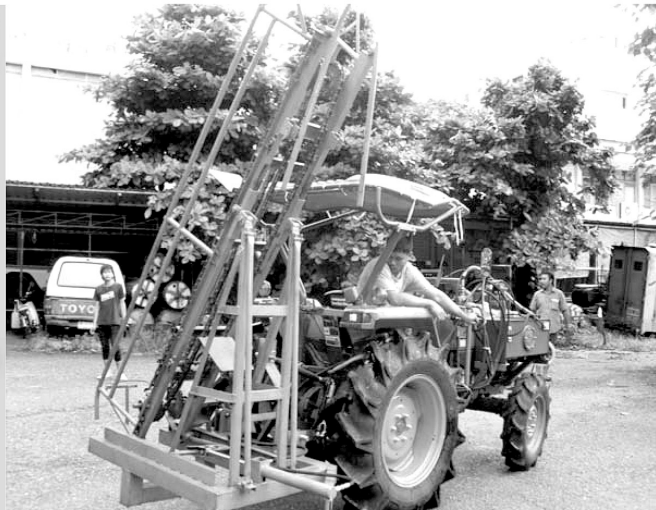
รูปที่ 2. แสดงอุปกรณ์ลำเลียงมันสำปะหลังขึ้นรถบรรทุกใช้งานร่วมกับรถแทรกเตอร์ส่วนประกอบต่างๆ (1)เฟืองขับล่าง (2)โครงเครื่อง (3)จุดต่อพ่วงรถแทรกเตอร์ (4)กระบอกไฮดรอลิกส์ปรับความสูงต่ำ (5)โซ่ลำเลียง (6)ชุดกันข้าง (7)ถาดรองเหง่ (8)เฟืองขับบน (9)ชุดควบคุมบังคับเร่งตก
