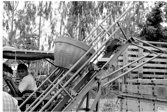
รูปที่ 3. รถบรรทุกจอดอยู่กับที่โดยมีอุปกรณ์ลำเลียงช่วยลำเลียงด้านท้ายโดยใช้แรงงานคนแบกเข่งวางบนอุปกรณ์ลำเลียง
