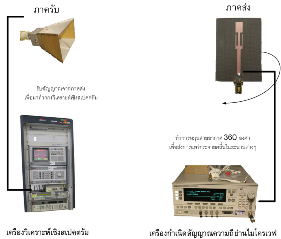
รูปที่ 10 ภาพการติดตั้งเครื่องมือและอุปกรณ์เพื่อทำการทดลองในห้องทดสอบแบบรูปการแพร่กระจายคลื่นแม่เหล็กไฟฟ้าของสายอากาศ
