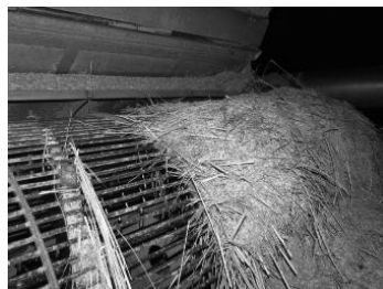
รูปที่ 3 การสะสมของวัสดุตกค้างในชุดสูนวด (ก, ข) และการงอกของเมล็ดที่สะสม (ค)
