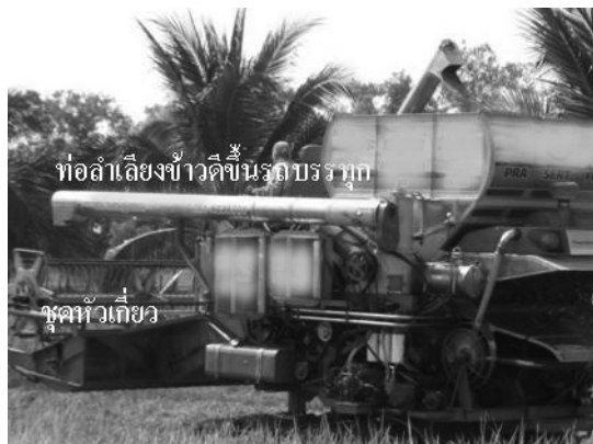
รูปที่ 1 อุปกรณ์การทำงานหลักของเครื่องเกี่ยวนวดข้าวที่ทำการเก็บข้อมูล
