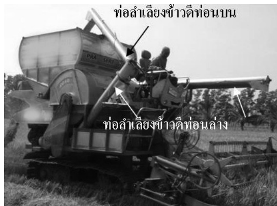
รูปที่ 1 อุปกรณ์การทำงานหลักของเครื่องเกี่ยวนวดข้าวที่ทำการเก็บข้อมูล
