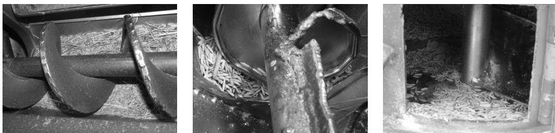
รูปที่ 5 วัสดุตกค้างในเกลียวนอนกลับไปนวดซ้ำ (ก, ข) และในเกลียวลำเลียงขึ้นถังเก็บ (ค)
