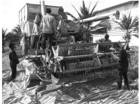
รูปที่ 2 การเก็บข้อมูลข้าวเปลือกและสิ่งเจือปนที่ตกค้างในอุปกรณ์การทำงานหลักของเครื่องเกี่ยวนวด
