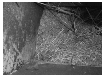
รูปที่ 3 การสะสมของวัสดุตกค้างในชุดสูนวด (ก, ข) และการงอกของเมล็ดที่สะสม (ค)
