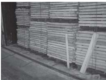
รูปที่ 4 ลักษณะของสายไฟที่ใช้ต่อออกมาเพื่อตรวจสอบค่าความชื้นของไม้
