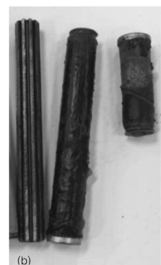
รูปที่ 8. ไส้กรองหม้อกาว (a) สภาพก่อนการใช้งาน (b) สภาพหลังการใช้งาน
