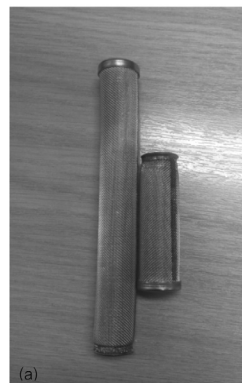
รูปที่ 8. ไส้กรองหม้อกาว (a) สภาพก่อนการใช้งาน (b) สภาพหลังการใช้งาน
