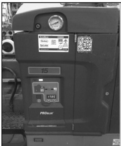
รูปที่ 7. แผงควบคุมหม้อกาว ใช้ปรับตั้งอุณหภูมิและความดัน
