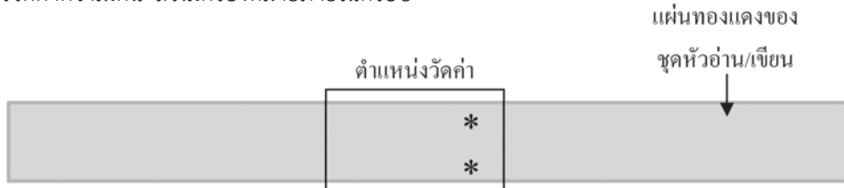
รูปที่ 6. ตำแหน่งการวัดค่า von Mises stress ของชิ้นงาน
