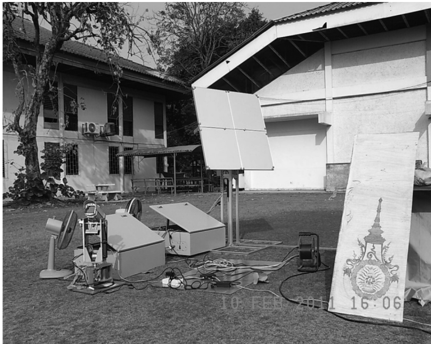
รูปที่ 10. การทดลองระบบติดตามดวงอาทิตย์และระบบสะท้อนแสงอาทิตย์
