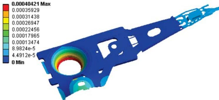
ก. ลักษณะการเสียรูปของ HGA ขณะถูกแรงจับยึดกระทำ (ภาพขยายขนาด 2300 เท่า)
