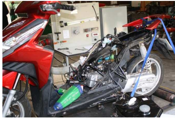
รูปที่ 6. การวัดค่าสมรรถนะของเครื่องยนต์
