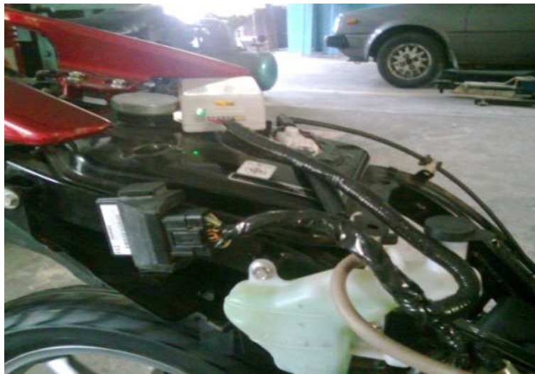
รูปที่ 2. การต่อกล่องควบคุมต้นแบบเข้ากับ ECM
