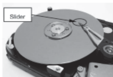
รูปที่ 1 แสดงตำแหน่งการทำงานของหัวอ่านเขียนสไลเดอร์
