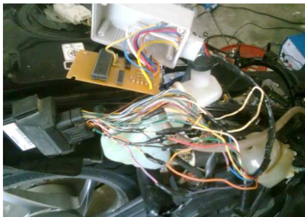
รูปที่ 4. การต่อกล่องวงจรควบคุมที่สร้างเข้ากับกล่อง ECM ของรถจักรยานยนต์
