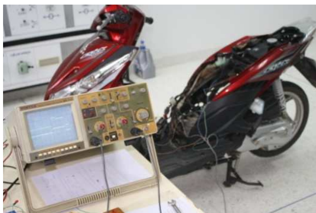
รูปที่ 5. การใช้ออสซิลโลสโคปวัดสัญญาณการส่งจ่ายน้ำมันของกล่อง ECM
