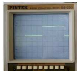
รูปที่ 10. รูปคลื่นที่ได้จากหัวฉีดของการจ่ายน้ำมันแก๊สโซฮอล์ E85
