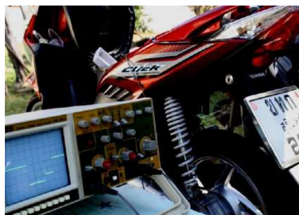
รูปที่ 17. การวัดสัญญาณขณะเครื่องยนต์ทำงานโดยใช้น้ำมันแก๊สโซฮอล์ E85 เป็นเชื้อเพลิง
