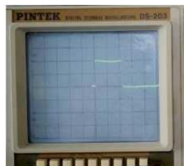
รูปที่ 8. รูปคลื่นที่ได้จากหัวฉีดของการจ่ายน้ำมันแก๊สโซฮอล์ 95 E10
