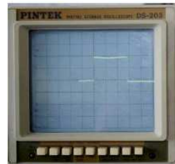
รูปที่ 9. รูปคลื่นที่ได้จากหัวฉีดของการจ่ายน้ำมันแก๊สโซฮอล์ E20
