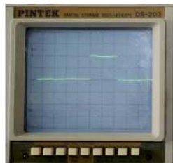
รูปที่ 7. รูปคลื่นที่ได้จากหัวฉีดของการจ่ายน้ำมันแก๊สโซฮอล์ 91 E10
