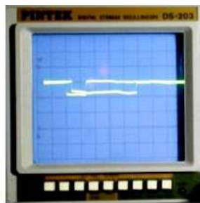
รูปที่ 15. คลื่นที่วัดได้ของการจ่ายน้ำมันของกล่อง ECM เทียบกับวงจรควบคุมที่สร้างขึ้น ในช่วงเวลาการเพิ่มคาบเวลาระยะที่สี่
