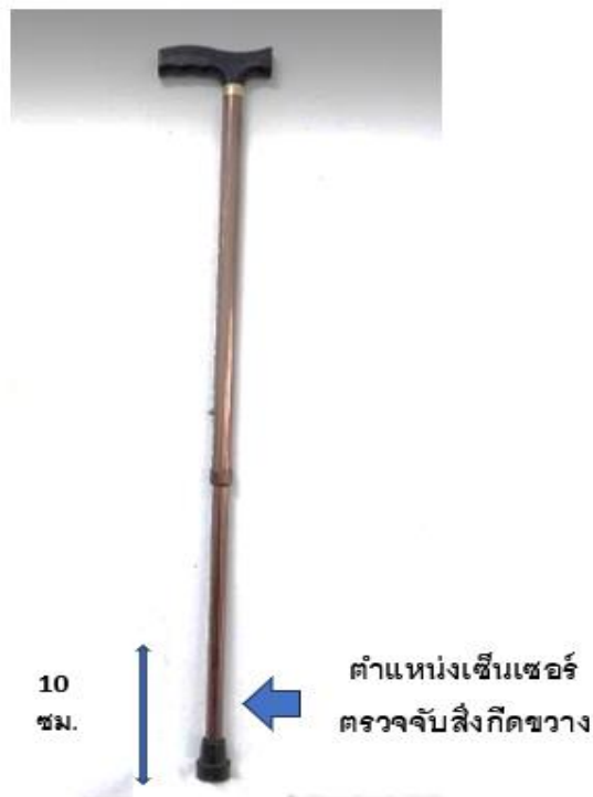
ภาพที่ 4 ไม้เท้าที่ติดตั้งเซ็นเซอร์ตรวจจับสิ่งกีดขวาง
