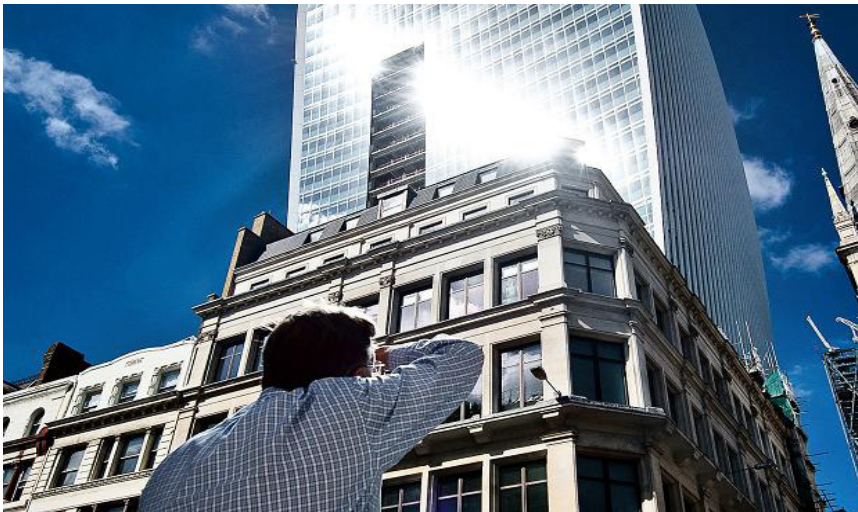
รูปที่ 2: แสงสว่างจ้าหรือแสงบาดตา(glare) อันเนื่องจากแสงสะท้อนของกระจกจากอาคารสูง 49
