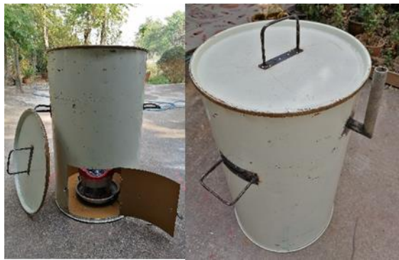
ภาพ 10 ประตูปานเปิด ปิด และท่อระบายอากาศ
