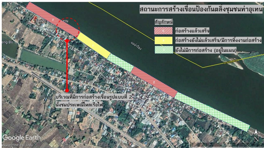
ภาพที่ 10 สถานะการร้งเขื่อนป้องกันตลิ่งแม่น้ำโขงชุมชนท่าอุเทน (ที่มา: ผู้วิจัยดัดแปลงและปรับปรุงจาก Google Earth, 2566)
