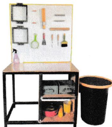
ภาพประกอบ 2 ชุดฝึกทักษะการปฏิบัติงานหล่อ ในแบบหล่อทราย
