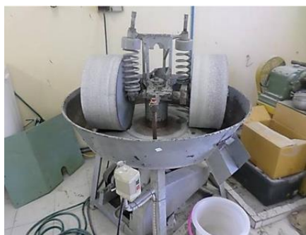
ภาพที่ 6 ขั้นตอนการบดขูดแก้วด้วยเครื่อง Edge Runner
