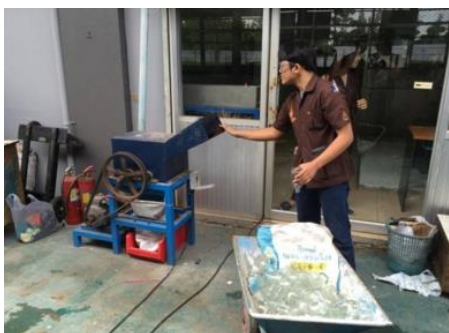
ภาพที่ 6 ขั้นตอนการบดขูดแก้วด้วยเครื่อง Edge Runner
