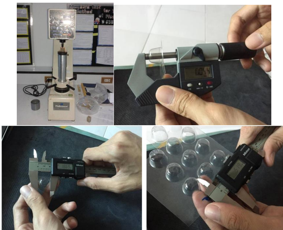
ภาพที่ 9 การวัดความแข็งและความหนาของชิ้นงาน
