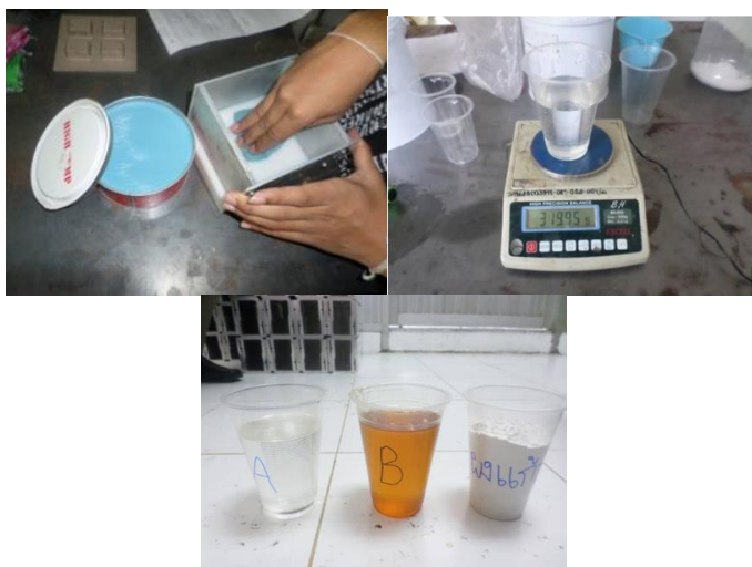
ภาพที่ 7 ขั้นตอนการหล่อแม่พิมพ์อีพอกซีเรซินผสมแก้ว
