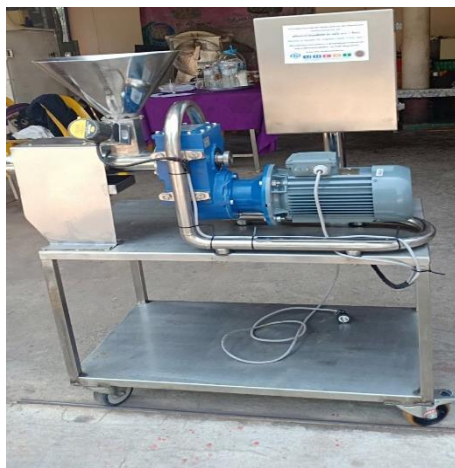
ภาพที่ 5 เครื่องบีบน้ำมันเมล็ด พืช ผัก ผลไม้ ตั้งสถานที่จริง
