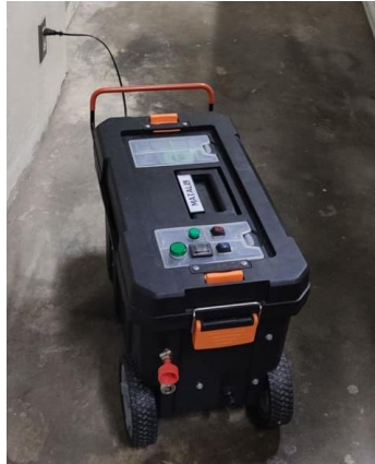
ภาพที่ 4 ชุดทำความสะอาดฟیلเตอร์และคอยล์ AHU
