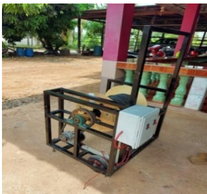
ภาพที่ 7 ประกอบโครงสร้างรถปล่อยสายไฟเบอร์ออฟติก และการติดตั้งวงจรควบคุมรถปล่อยสายไฟเบอร์ออฟติก
