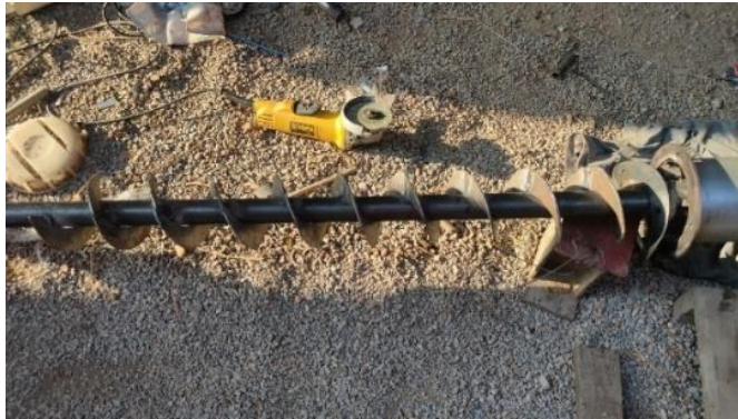
ภาพที่ 3 เฟลสกรูที่ผ่านการเชื่อมเสร็จสมบูรณ์
