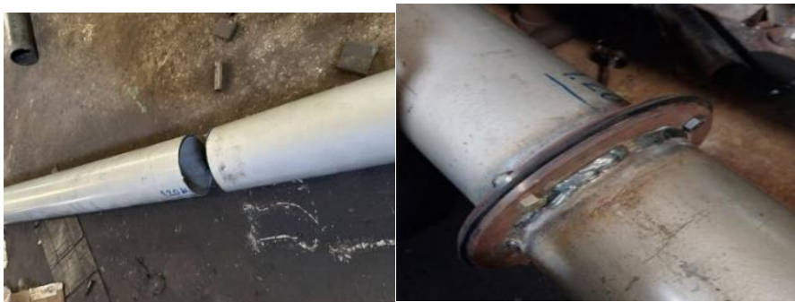
ภาพที่ 5 การประกอบท่อทั้งสองส่วนเข้าด้วยกัน โดยใช้หน้าจานเชื่อมสำหรับยึดและขันน็อต
