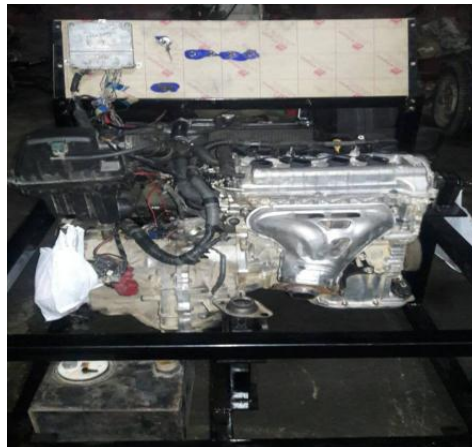
ภาพที่ 2 ชุดฝึกวิเคราะห์ปัญหาระบบควบคุมด้วยอิเล็กทรอนิกส์รถยนต์
