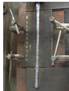
ภาพที่ 2 ชิ้นงานจริงที่ทำการเชื่อมด้วยกรรมวิธีการเชื่อมอาร์กโลหะแก๊สคลุม
