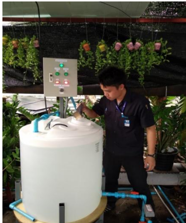
ภาพที่ 4 การใส่ผลิตภัณฑ์จุลินทรีย์ลงในถังและการตั้งเวลาเครื่องเติมจุลินทรีย์อัตโนมัติ
