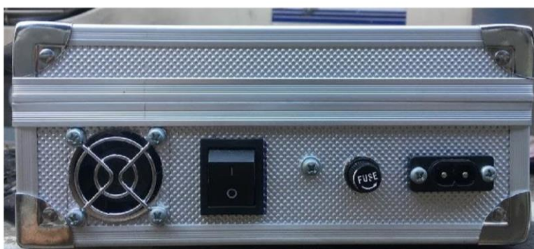
ภาพที่ 6 ติดตั้งอุปกรณ์ด้านข้างของชุดทดสอบล๊อคประตูด้วยแม่เหล็กไฟฟ้า
