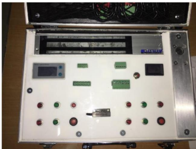
ภาพที่ 5 ติดตั้งอุปกรณ์ด้านหน้าของชุดทดสอบล๊อคประตูด้วยแม่เหล็กไฟฟ้า
