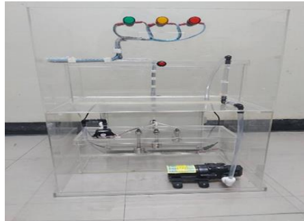
ภาพที่ 5 ชุดสาธิตเซนเซอร์ตรวจจับน้ำโสโครกล้นแจ้งเตือนผ่านแอปพลิเคชันไลน์
