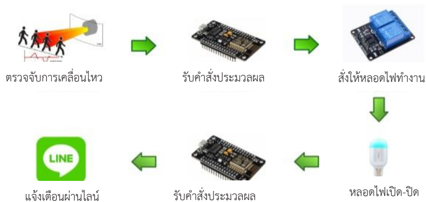
ภาพที่ 3 การทำงานของชุดสาธิตเปิด-ปิดไฟฟ้าแสงสว่าง ด้วยการเคลื่อนไหวและแจ้งผ่านแอปพลิเคชันไลน์
