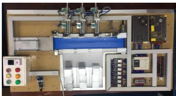
ภาพที่ 4 เครื่องตัดแยกชิ้นงาน 3 ระดับอัตโนมัติบนสายพานลำเลียง
