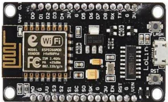
ภาพที่ 2 บอร์ด Node MCU ESP8266 V.2
