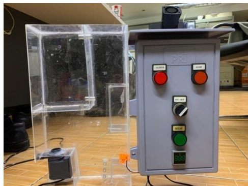
ภาพที่ 5 เซ็นเซอร์ตรวจจับน้ำท่วมและส่งสัญญาณผ่านไลน์
