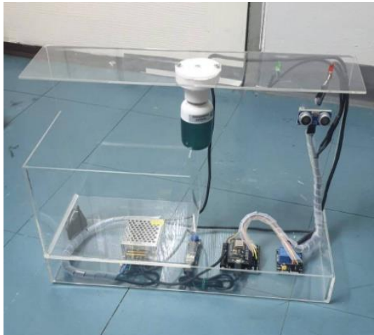
ภาพที่ 5 ชุดสาธิตเปิด-ปิดไฟฟ้าแสงสว่างด้วยการเคลื่อนไหวและแจ้งผ่านแอปพลิเคชันไลน์
