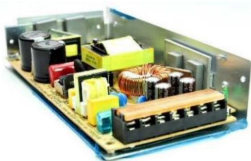
ภาพที่ 1 สวิตซ์ชิ่งเพาเวอร์ซัพพลาย
