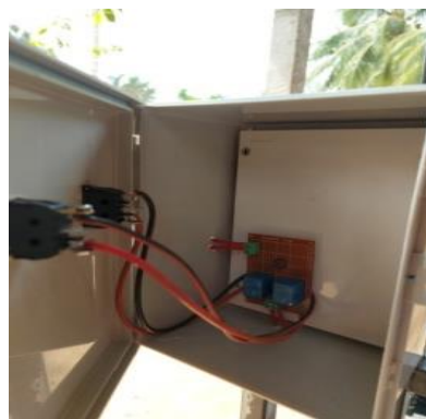
ภาพที่ 7 ประกอบโครงสร้างรถปล่อยสายไฟเบอร์ออฟติก และการติดตั้งวงจรควบคุมรถปล่อยสายไฟเบอร์ออฟติก
