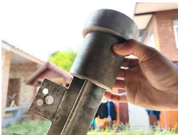
ภาพที่ 3 การนำชิ้นงานหลังการกลึงปรับขนาดและรูปทรง ไปทดลองสวมกับหลักกราวด์ ที่ใช้งานจริงในระบบไฟฟ้า
