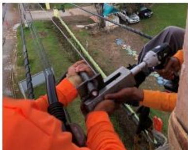
ภาพที่ 3 การทดสอบการใช้งานจริงบนเสาไฟฟ้ากับบล็อกไฟฟ้า
