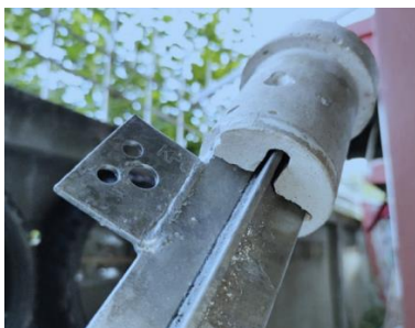
ก. แบบร่างชิ้นงาน ข. ต้นแบบจากปูนพลาสติกอร์ไปทดลองสวมกับ หลักกราวด์ที่ใช้งานจริง
