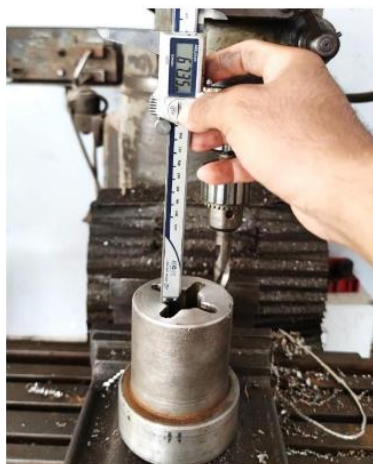
ภาพที่ 3 การนำชิ้นงานหลังการกลึงปรับขนาดและรูปทรง ไปทดลองสวมกับหลักกราวด์ ที่ใช้งานจริงในระบบไฟฟ้า
