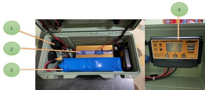
รูปที่ 16 แสดงชิ้นส่วนอุปกรณ์ภายในกล่องเก็บพลังงานอเนกประสงค์
