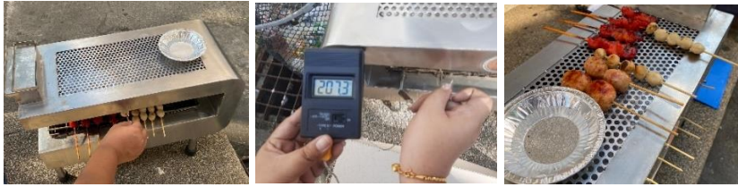
รูปที่ 8 ทดสอบประสิทธิภาพเชิงความร้อนของเตาประหยัดพลังงานปลอดสารพิษ
