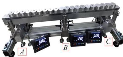
ภาพที่ 19 เปลี่ยนขนาดฐานรองโพลีเซลล์ จากให้ใหญ่ขึ้น
