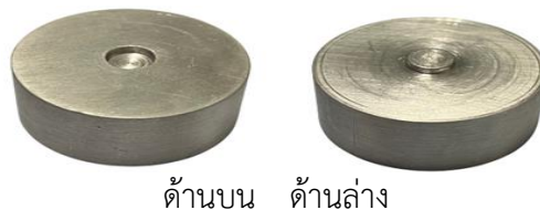
ภาพที่ 11 ตุ้มน้ำหนักทำหน้าที่เสมือนแรงที่มากระทำบนคาน
