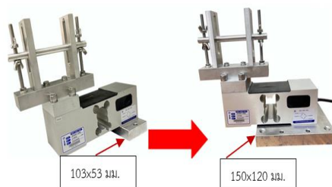
ภาพที่ 19 เปลี่ยนขนาดฐานรองโพลีเซลล์ จากให้ใหญ่ขึ้น
