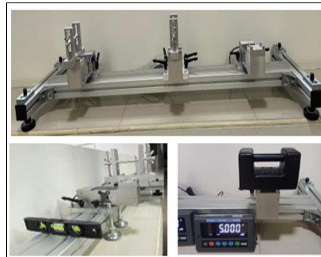
ภาพที่ 17 การติดตั้งและสอบความเที่ยงตรงของโหลดเซลล์
