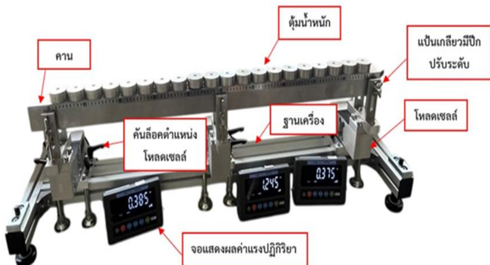
ภาพที่ 18 ชุดสาธิตที่ประกอบเสร็จเรียบร้อยแล้ว ขนาดชุดสาธิตกว้าง 0.4 m ยาว 1.3 m สูง 0.4 m
