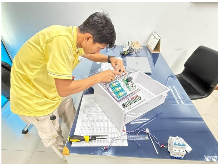
ภาพที่ 2 การจัดเตรียมวัสดุ อุปกรณ์ ของการออกแบบและพัฒนาระบบการประยุกต์ใช้เทคโนโลยีอินเทอร์เน็ตของสรรพสิ่งสำหรับแจ้งเตือนแรงดันไฟฟ้าตกในระบบไฟฟ้า
