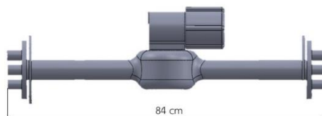
รูปที่ 5 เพลลาหน้า-หลังของรถขนส่งอาหารพลังงานไฟฟ้า ยาว 84 เซนติเมตร
