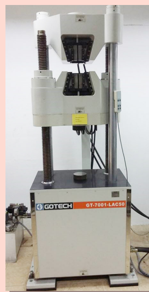
ภาพที่ 7 เครื่องทดสอบหาแรงที่ใช้ในการผ่าผลหมากรัง (ยี่ห้อ Gotech type : GT-700I-LAC50)
