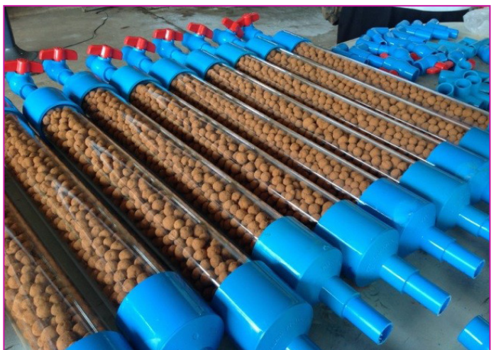
ภาพที่ 3 ชุดกำจัดก๊าซไฮโดรเจนซัลไฟด์ในก๊าซชีวภาพสำหรับเกษตรกรรายย่อย
