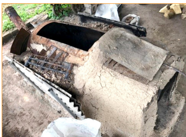
ภาพที่ 4 เตาเผาถ่านขนาดถึง 200 ลิตร แบบนอน
