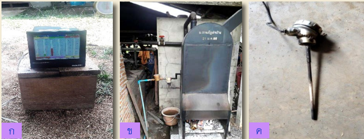
ภาพที่ 9 อุปกรณ์สำหรับเก็บข้อมูลเพื่อนำมาคำนวณในสมการค่าประสิทธิภาพเชิงความร้อน (ณัฐพงษ์ ตาปัญญา และคณะ, 2561)
