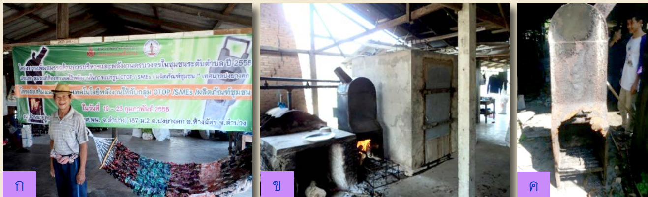
ภาพที่ 2 ที่มาและความสำคัญของนวัตกรรมการจัดการพลังงานโดยชุมชน ก) สมาชิกที่สมัครใจใช้งานเตาไอน้ำนึ่งก้อนวัสดุเพาะเห็ด ๒) การติดตั้งเตาไอน้ำนึ่งก้อนวัสดุเพาะเห็ด ๓) สภาพเตาไอน้ำนึ่งก้อนวัสดุเพาะเห็ดประหยัดพื้นที่เป็นโครงสร้างหลัก เมื่อใช้งานแล้ว 2 ปี
