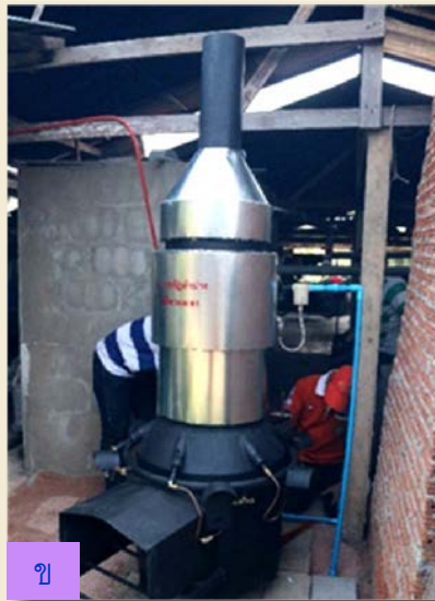
ภาพที่ 4 นวัตกรรมจัดการพลังงานที่ออกแบบโดยนักวิชาการ ก) เตาไอน้ำนึ่งก้อนวัสดุเพาะเห็ดประหยัดฟืนชุดท่อน้ำ 3 ทบ ข) เตาไอน้ำนึ่งก้อนวัสดุเพาะเห็ดที่สามารถใช้งานกับเชื้อเพลิงแข็ง (ฟืน) และก๊าซหุงต้ม ค) เตาไอน้ำนึ่งก้อนวัสดุเพาะเห็ดประหยัดฟืนชุดท่อน้ำ 1 ทบ
