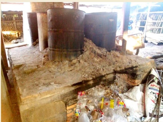
ภาพที่ 1 เตาไอน้ำรูปแบบเดิมซึ่งเป็นเตาไอน้ำรูปแบบถัง 200 ลิตร
