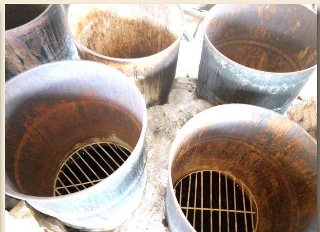
ภาพที่ 1 เตาไอน้ำรูปแบบเดิมซึ่งเป็นเตาไอน้ำรูปแบบถัง 200 ลิตร
