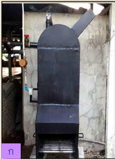
ภาพที่ 4 นวัตกรรมจัดการพลังงานที่ออกแบบโดยนักวิชาการ ก) เตาไอน้ำนึ่งก้อนวัสดุเพาะเห็ดประหยัดฟืนชุดท่อน้ำ 3 ทบ ข) เตาไอน้ำนึ่งก้อนวัสดุเพาะเห็ดที่สามารถใช้งานกับเชื้อเพลิงแข็ง (ฟืน) และก๊าซหุงต้ม ค) เตาไอน้ำนึ่งก้อนวัสดุเพาะเห็ดประหยัดฟืนชุดท่อน้ำ 1 ทบ
