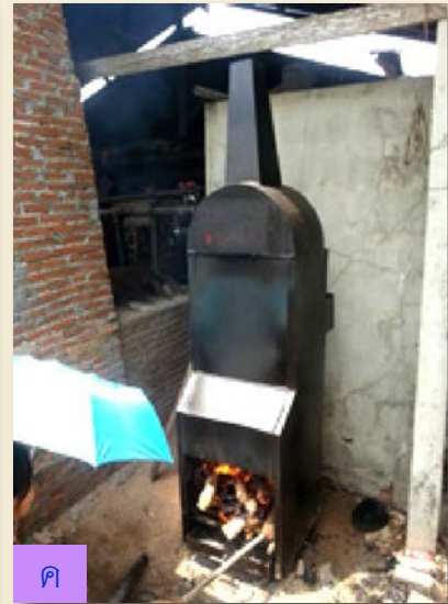
ภาพที่ 4 นวัตกรรมจัดการพลังงานที่ออกแบบโดยนักวิชาการ ก) เตาไอน้ำนึ่งก้อนวัสดุเพาะเห็ดประหยัดฟืนชุดท่อน้ำ 3 ทบ ข) เตาไอน้ำนึ่งก้อนวัสดุเพาะเห็ดที่สามารถใช้งานกับเชื้อเพลิงแข็ง (ฟืน) และก๊าซหุงต้ม ค) เตาไอน้ำนึ่งก้อนวัสดุเพาะเห็ดประหยัดฟืนชุดท่อน้ำ 1 ทบ
