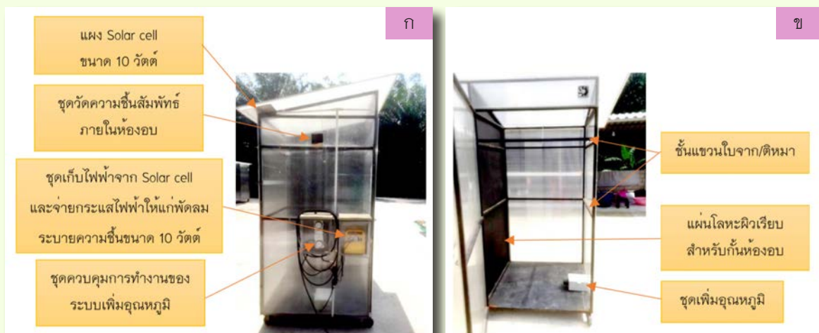
ภาพที่ 16 ลักษณะเทคโนโลยีตู้อบพลังงานแสงอาทิตย์ที่ได้ปรับปรุง ก) ด้านข้างติดตั้งชุดควบคุมอุณหภูมิ และชุดเซลล์แสงอาทิตย์ และ ข) ลักษณะของห้องอบที่แบ่งเป็น 2 ห้อง พร้อมติดตั้งชุดเพิ่มอุณหภูมิในห้องอบ
