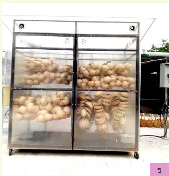
ภาพที่ 17 การใช้งานเทคโนโลยีตู้อบพลังงานแสงอาทิตย์ที่ได้ปรับปรุง ก) รูปแบบการจัดวางวัตถุดิบ (ใบจากและติหมาใบจาก) เพื่อใช้ในการอบ และ ข) การนำเทคโนโลยีจากผลงานวิจัยไปใช้อบติหมาใบจากให้มีคุณภาพดีขึ้นก่อนนำออกจำหน่าย
