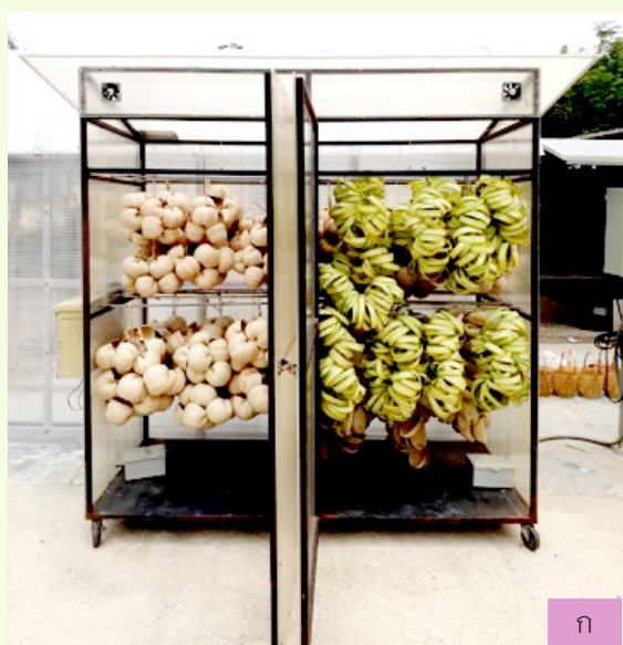
ภาพที่ 17 การใช้งานเทคโนโลยีตู้อบพลังงานแสงอาทิตย์ที่ได้ปรับปรุง ก) รูปแบบการจัดวางวัตถุดิบ (ใบจากและติหมาใบจาก) เพื่อใช้ในการอบ และ ข) การนำเทคโนโลยีจากผลงานวิจัยไปใช้อบติหมาใบจากให้มีคุณภาพดีขึ้นก่อนนำออกจำหน่าย
