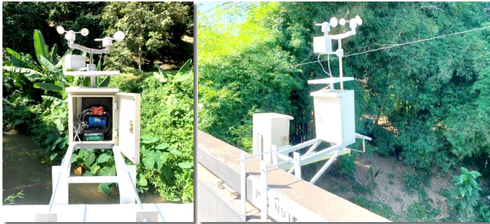
ภาพที่ 2 อุปกรณ์สถานีตรวจวัดข้อมูลสภาพแวดล้อมอัตโนมัติ
