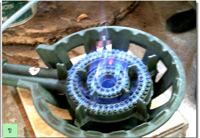
ภาพที่ 7 การทดสอบประสิทธิภาพแก๊สชีวภาพ ก) การใช้งานแก๊สชีวภาพ ข) ลักษณะเปลวไฟที่ได้จากแก๊สชีวภาพ
