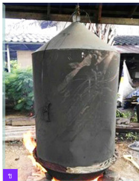
ภาพที่ 4 ปัญหาของการใช้เตาในการแปรรูปสมุนไพรของวิสาหกิจชุมชนสมุนไพรคุณธรรมวัดคูเต่า ก) การแปรรูปสมุนไพรที่เกิดควันและมีค่าความร้อนต่ำ และ ข) การแปรรูปสมุนไพรที่มีการสูญเสียความร้อนสูง
