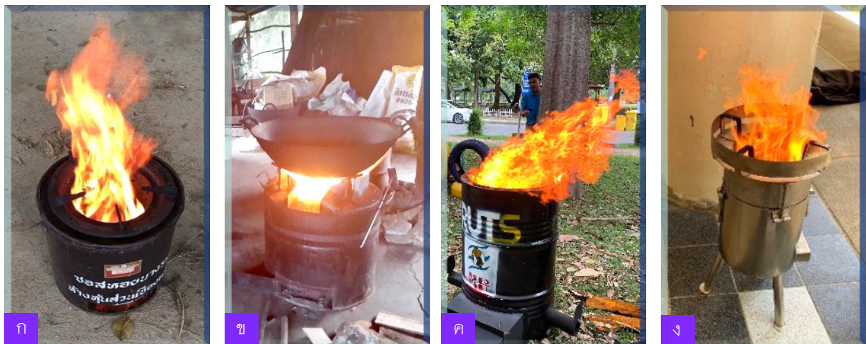
ภาพที่ 7 ลักษณะเตาประหยัดพลังงานที่ออกแบบและพัฒนา เพื่อประยุกต์ใช้ในชุมชนลุ่มน้ำคลองอู่ตะเภาและวิสาหกิจชุมชน ก) เตาประหยัดพลังงานชนิดถังโลหะขนาด 20 ลิตร ข) เตาประหยัดพลังงานชนิดถังโลหะ 200 ลิตร รูปทรงต่ำ ค) เตาประหยัดพลังงานชนิดถังโลหะ 200 ลิตร รูปทรงสูง และ ง) เตาประหยัดพลังงานสำหรับการแปรรูปสมุนไพร
