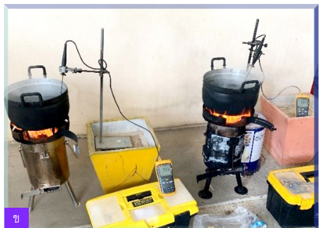
ภาพที่ 8 การทดสอบเตาประหยัดพลังงานต้นแบบ ก) การทดสอบเตา หาค่าประสิทธิภาพและวัดค่าฝุ่น PM2.5 ข) การทดสอบค่าประสิทธิภาพเชิงความร้อนของเตา โดยเปรียบเทียบสมรรถนะจากปริมาตรห้องเผาไหม้ 3 ระดับ
