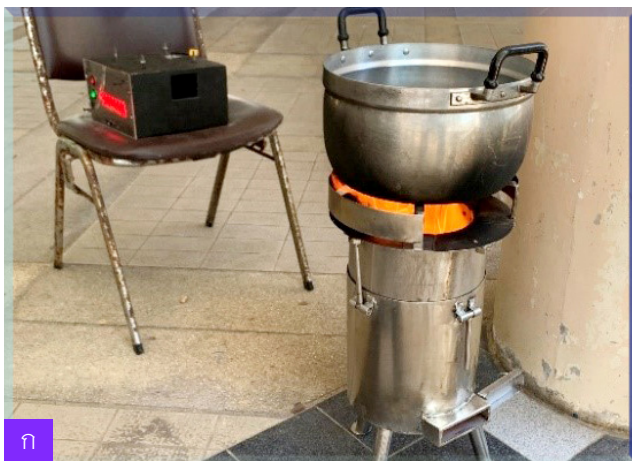
ภาพที่ 8 การทดสอบเตาประหยัดพลังงานต้นแบบ ก) การทดสอบเตา หาค่าประสิทธิภาพและวัดค่าฝุ่น PM2.5 ข) การทดสอบค่าประสิทธิภาพเชิงความร้อนของเตา โดยเปรียบเทียบสมรรถนะจากปริมาตรห้องเผาไหม้ 3 ระดับ
