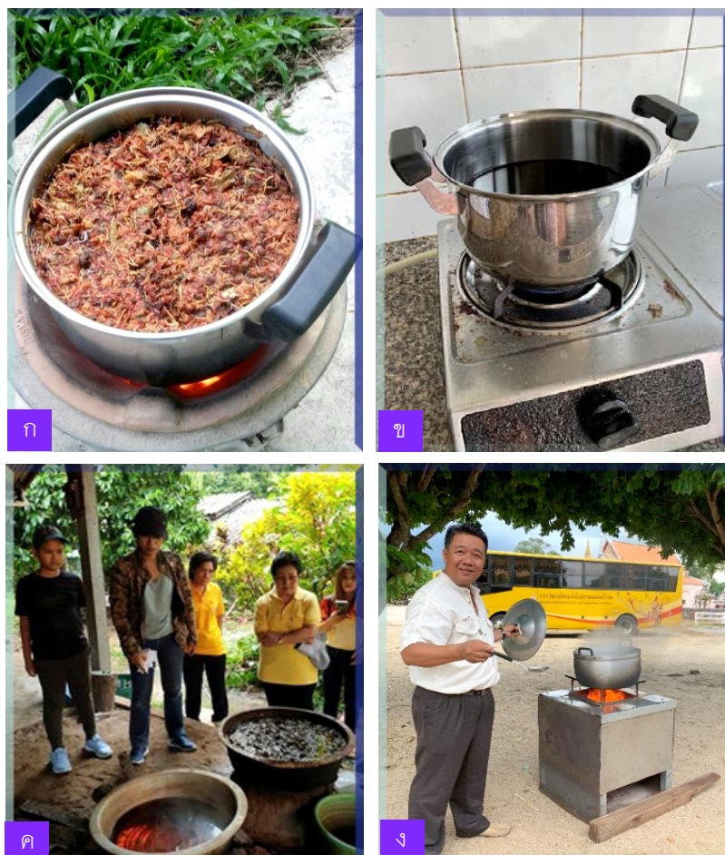
ภาพที่ 2 การใช้เตาประเภทต่าง ๆ ในการแปรรูปสมุนไพรของวิสาหกิจชุมชนสมุนไพรคุณธรรมวัดคูเต่า จังหวัดสงขลา ก) เตาท้องถิ่น (เตาอั้งโล่) ข) เตาแก๊สหุงต้ม (LPG) ค) เตาท้องถิ่น (ดั้งเดิม) และ ง) เตาชีวมวลรูปแบบเดิม
