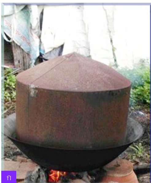
ภาพที่ 4 ปัญหาของการใช้เตาในการแปรรูปสมุนไพรของวิสาหกิจชุมชนสมุนไพรคุณธรรมวัดคูเต่า ก) การแปรรูปสมุนไพรที่เกิดควันและมีค่าความร้อนต่ำ และ ข) การแปรรูปสมุนไพรที่มีการสูญเสียความร้อนสูง
