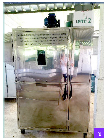
ภาพที่ 8 ก) การออกแบบวิศวกรรมของเครื่องอบแห้ง และ ข) เครื่องอบแห้งควบคุมแบบ Multi-stage drying system controller
