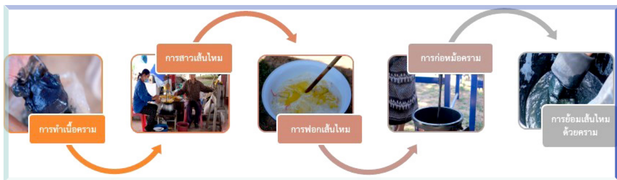
ภาพที่ 2 กระบวนการย้อมเส้นไหมด้วยคราม ของกลุ่มทอผ้าไหมบ้านกลาง
